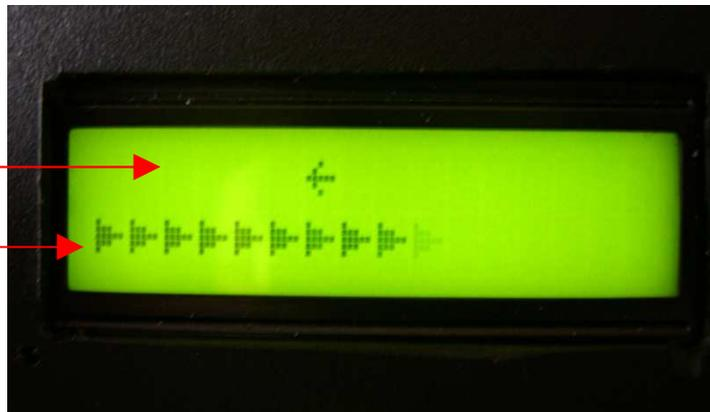
Per effettuare la calibrazione visiva, basta selezionare la modalità *Calibrazione*. Si accede così alla « visualizzazione » del livello sonoro attualmente rilevato dal microfono. Costaterete così che, quando si produce un suono, le frecce si accendono verso destra in funzione della potenza del suono emesso. Se non ci sono rumori, nessuna freccia deve apparire. Una vite di calibrazione permette di impostare la sensibilità desiderata.
