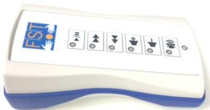
Dans le domaine du handicap, un contacteur est simplement un interrupteur que l'utilisateur peut actionner avec n'importe quelle partie de son corps. Le système de balayage consiste en la présentation successive de différentes fonctions, l'une après l'autre avec une durée de présentation de x secondes.
