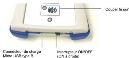
Connecteur de charge Micro USB type B Interrupteur ON/OFF (ON à droite)
